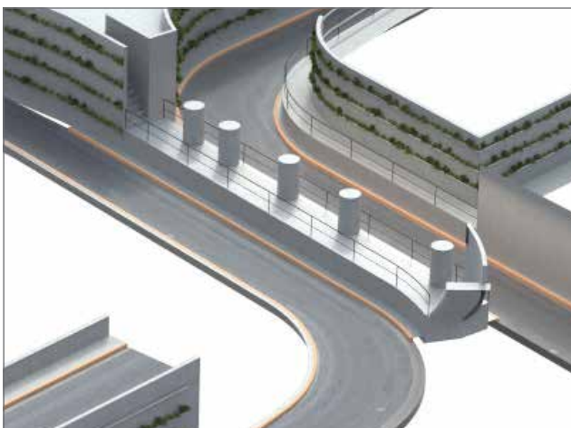
Detalle del paso peatonal en el interior de la obra.
